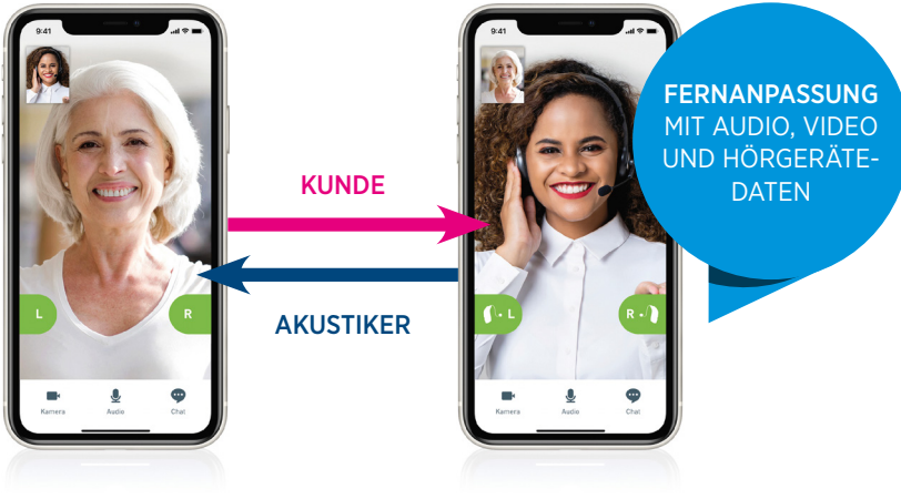
Abbildung 2: Funktionsprinzip der Hörgerätefern-anpassung, wobei das Smartphone des Hörgerätenutzers als Schnittstelle zu den Hörgeräten dient (Bildquelle: Bernafon Hörgeräte GmbH, Berlin)
